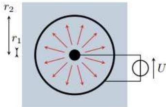
L'électrode de travail et la contre-électrode d'un électrolyseur sont constituées de deux cylindres coaxiaux de rayons  $r_1 < r_2$  plongeant sur une hauteur  $h$  dans une solution électrolytique de conductivité  $\sigma$  supposée uniforme et constante. Une tension  $U = V(r_1) - V(r_2) > 0$  est imposée entre les deux électrodes. On suppose le régime stationnaire atteint. La densité de courant dans la solution s'écrit alors sous la forme
