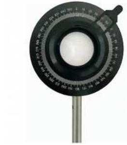
Utilisation : elle permet de faire tourner la direction de polarisation d'une lumière polarisée rectilignement.
