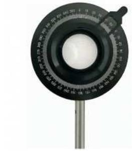
Utilisation : elle permet de faire tourner la direction de polarisation d'une lumière polarisée rectilignement.
