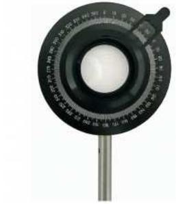
Utilisation 1: on transforme une polarisation rectiligne en une polarisation circulaire
