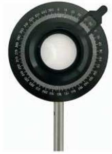
*Utilisation 1:* le polariseur sert à fabriquer une lumière polarisée rectilignement. la lumière qui sort d'un polariseur est polarisée rectilignement dans la direction de l'axe principal du polariseur.
