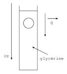
Montrer par un calcul numérique que l'on peut négliger la poussée d'Archimède devant la force poids. On écrit le vecteur vitesse sous la forme  $\overrightarrow{v} = v(t)\overrightarrow{e_z}$ . Déduire de la RFD appliquée à la bille, l'équation différentielle vérifiée par v(t). Préciser la constante de temps du régime transitoire et calculer la viscosité de la glycérine sachant que la vitesse limite atteinte par la bille est  $v_l = 11, 4 \ cm.s^{-1}$ .
