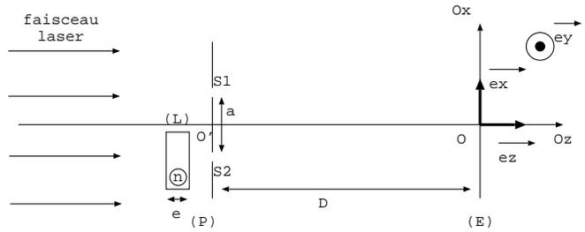
**7.** Les rayons du faisceau laser ne sont plus parallèles à l'axe  $Oz$ . Ils sont inclinés d'un angle  $\alpha$  petit par rapport à cet axe. Exprimer la différence de marche  $\delta''_{2/1}(M)$  en un point d'abscisse  $x$  sur l'écran. En déduire en fonction de  $a$  et  $\alpha$  la position de la frange centrale. Dans quel sens les franges ont-elles défilé?
