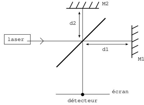
2. On place au centre de l'écran un détecteur qui délivre une tension proportionnelle à l'intensité lumineuse. On chariote le miroir  $M_1$  à la vitesse  $v = 1,58 \mu\text{m}\cdot\text{s}^{-1}$ . On donne la courbe représentant la tension aux bornes du détecteur en fonction du temps. Mesurer sur la courbe la période des oscillations et préciser à quoi correspondent les maxima et les minima d'intensité.
