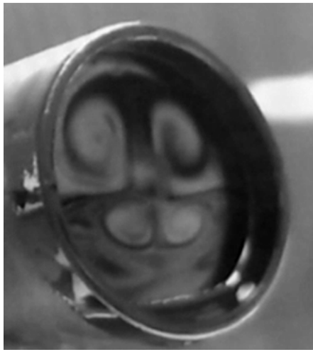
Figure 7 Photographie de la figure d'interférence (à gauche) et représentation schématique associée du mouvement du cylindre (grisé) et des tourbillons générés (à droite)
