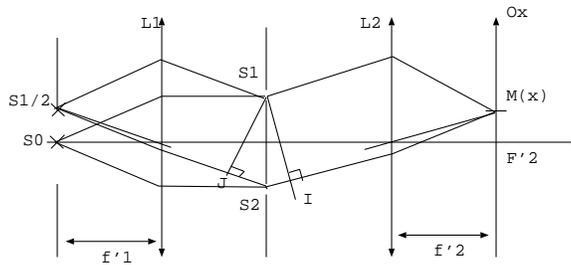
Dans ce montage on a  $\delta_{S_0}(M) = S_2 I = \frac{ax}{f'_2}$  (démonstration voir cours) soit  $p_{S_0}(M) = \frac{ax}{\lambda f'_2}$  et  $\delta_{S_{1/2}}(M) = J S_2 + S_2 I = \frac{ab}{2\lambda f'_1} + \frac{ax}{\lambda f'_2}$  soit  $p_{S_{1/2}}(M) = \frac{ab}{2\lambda f'_1} + \frac{ax}{\lambda f'_2}$ .
