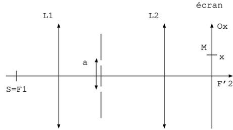
2. Soit le dispositif d'Young composé de deux sources secondaires  $S_1$  et  $S_2$  distantes de  $a$  éclairées par une source ponctuelle  $S$  placé sur l'axe optique. On observe sur un écran placé à une distance  $D$  des sources secondaires. La source a pour longueur d'onde  $\lambda$ .
