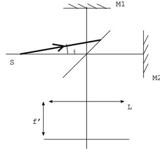
3. On réalise un montage avec l'interféromètre de Michelson et deux lentilles  $L_1$  et  $L_2$  de focales images respectives  $f'_1 = 10 \text{ cm}$  et  $f'_2 = 60 \text{ cm}$ . On observe à l'écran des franges circulaires. Préciser la configuration de l'interféromètre. Faire un schéma du dispositif expérimental (en justifiant le choix des lentilles). Calculer le rayon du 3<sup>ème</sup> anneau brillant. Données :  $\lambda = 632 \text{ nm}$ ,  $e = 870 \text{ }\mu\text{m}$ .
