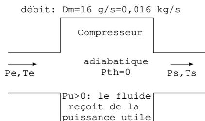
1. On applique le premier principe industriel au fluide dans le compresseur, l'énoncé de donne aucune vitesse et aucune hauteur donc on néglige les variations d'énergie cinétique et d'énergie potentielle.
