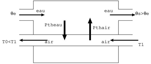
Réfléchissons un peu: L'idée est d'appliquer le premier principe industriel. On peut l'appliquer à trois systèmes différents: l'eau, l'air ou le système eau+air.
