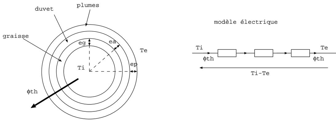
La résistance thermique de la couche de graisse est  $R_g = \frac{1}{\lambda_g 2\pi l} \ln\left(\frac{R + e_g}{R}\right)$
