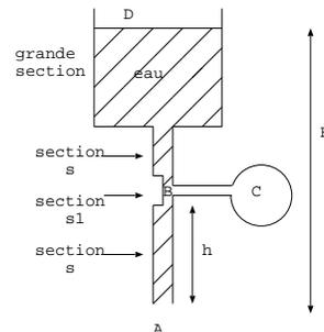
On donne  $H = 50 \text{ cm}$ ,  $h = 10 \text{ cm}$ ,  $s = 1 \text{ cm}^2$  et  $g = 10 \text{ m/s}^2$ . Déduire de la conservation du débit volumique et de la relation de Bernoulli, les vitesses  $v_A$  et  $v_B$  de l'eau aux points  $A$  et  $B$ , et la pression de l'air dans  $C$ .
