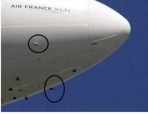
Le tube de Pitot est une sonde très rustique mais essentielle à la sécurité de tous les avions puisqu'elle donne une mesure de la vitesse. Les tubes de Pitot sont dégivrés régulièrement et une défaillance de l'un d'eux peut causer une chute de l'appareil.
