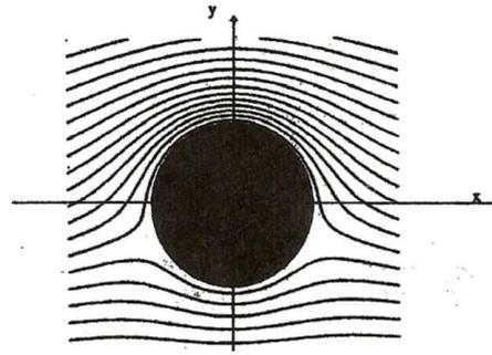
On étudie l'écoulement de l'air autour d'une balle assimilée à une sphère. La vitesse de l'air par rapport à la balle est selon  $+Ox$ . La balle a été mise en rotation selon  $-Oz$  (voir son sens de rotation sur le schéma).
