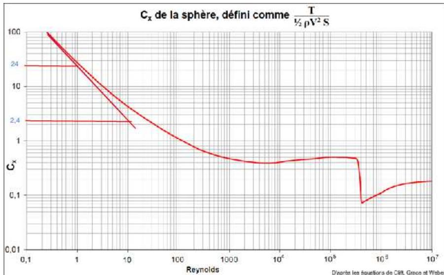
On étudie ici l'écoulement de l'eau autour d'une bactérie. La bactérie de rayon  $R = 100 \mu\text{m}$  se déplace à la vitesse  $v = 2 \text{ mm.s}^{-1}$  dans l'eau liquide de viscosité  $\eta = 10^{-3} \text{ Pa.s}$ .
