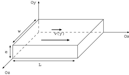
Le frottement entre deux couches de fluide voisines se traduit par une force tangentielle de viscosité parallèle à la direction de l'écoulement dont la norme s'écrit  $F_{vis} = \eta S \frac{\partial v}{\partial y}$ ,  $S$  étant la surface de contact entre les couches de fluide.
