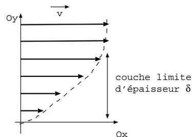
Dans cette section, on néglige les effets de la pesanteur, les gradients de pression sont considérés nuls et l'écoulement est instationnaire.
