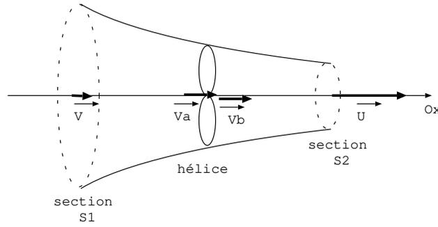
1. Les lignes de courant se resserrent, cela signifie que la vitesse augmente. Effectivement, le ventilateur reçoit de l'énergie électrique qui fait tourner l'hélice et le fluide est accéléré.
