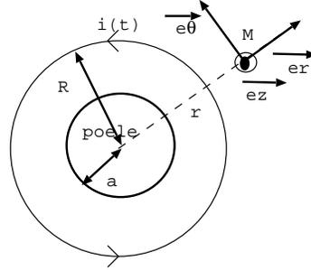
Dans un souci de simplification, on suppose que le champ magnétique  $\vec{B}(M, t)$  créé par la spire dans la poêle est uniforme. On donne :  $B(M, t) = \frac{\mu_0 \mu_r i(t)}{2R}$ .
