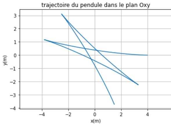
**5.e.** On fait une simulation en prenant  $\omega = -\Omega_T * 250$  (ligne 10). On obtient la trajectoire suivante pour le pendule. De quel angle  $\alpha'$  a tourné le plan d'oscillations? Dans quel sens a tourné le plan d'oscillations du pendule? Vérifier la cohérence avec la valeur de  $\omega$  choisie pour cette simulation.
