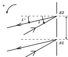
On suppose que le réseau est éclairé par des ondes planes, de longueur d'onde  $\lambda$  dans le vide, sous l'angle d'incidence orienté  $i$  et on s'intéresse aux ondes planes diffractées sous l'angle d'émergence orienté  $i'$ .
