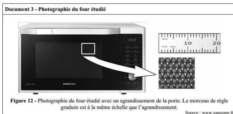
La grille contenue dans la porte du four peut être vue comme un réseau bidimensionnel. Ce réseau doit réfléchir les ondes électromagnétiques comme s'il s'agissait d'une paroi métallique pleine. Afin de simplifier son étude, nous le modélisons par un réseau simplement périodique constitué de fentes fines équidistantes séparées de  $a$  et parallèles à l'axe  $Oz$ .
