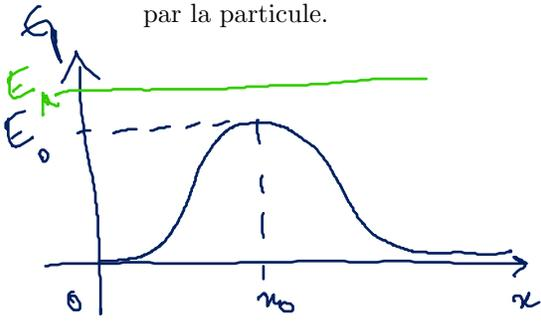
$$E_m = E_c + E_p = \frac{mv^2}{2} + E_p \quad \text{donc le m.v. n'est possible que pour } E_m \geq E_p(x)$$
