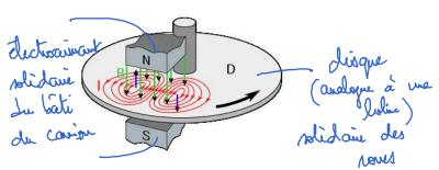
Le freinage généré par les courants est d'autant plus intense que le disque et la roue tournent vite et réciproquement, plus la roue et le disque tournent lentement et moins le freinage est efficace. A l'arrêt ce dispositif de freinage ne fonctionne pas. Ce type de freinage ne peut donc être que complémentaire d'un freinage classique.
