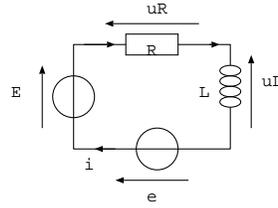
Loi des mailles:  $e + E = u_R + u_L$  avec  $u_R = Ri$  et  $u_L = L\frac{di}{dt}$ . d'où l'équation:  $Ri + L\frac{di}{dt} = -Blv + E$ : l'équation électrique contient le terme mécanique  $v$ .
