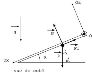
On combine les équations électrique et mécanique:  $m\frac{dv}{dt} = mg \sin \alpha - \frac{B^2 a^2}{R}v$  soit à résoudre  $\frac{dv}{dt} + \frac{B^2 a^2}{mR}v = g \sin \alpha$ . On pose  $\tau = \frac{mR}{B^2 a^2}$ .
