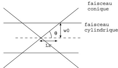
Le faisceau conique diverge et la largeur de la tache sur la lune est donnée par  $\tan \theta \approx \theta = \frac{d_L/2}{D}$  soit  $d_L = 2D\theta = 2,4 \text{ km}$ .
