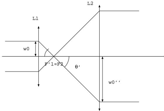
5. Le waist du faisceau émergent se trouve dans le plan focal image de la lentille  $L_1$  et on a  $\tan \theta' = \frac{w_0}{f'_1} \approx$
