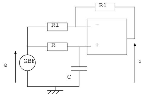
1. Justifier le fait que l'ALI fonctionne en régime linéaire et établir la fonction de transfert  $\underline{H} = \frac{i_e}{e}$  en fonction de  $R$ ,  $C$  et  $\omega$ .
