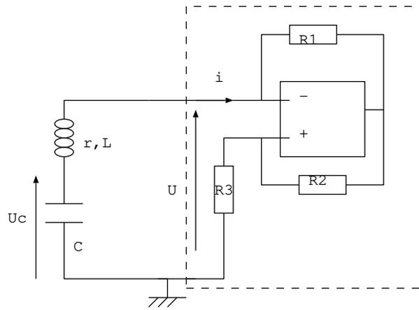
2. Montrer que  $U_c(t)$  vérifie l'équation différentielle de la forme  $\frac{d^2 U_c}{dt^2} + \frac{1}{\tau} \left(1 - \frac{R_1 R_3}{R_2 r}\right) \frac{dU_c}{dt} + \omega_0^2 U_c = 0$ . Exprimer  $\tau$  et  $\omega_0$  en fonction de  $r$ ,  $L$  et  $C$ .
