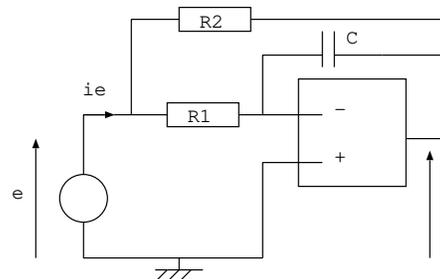
Réponse:  $R = \frac{R_1 R_2}{R_1 + R_2}$  et  $L = R_1 R_2 C$
