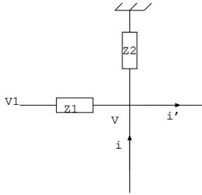
Remarque: Millman est le résultat d'un loi des noeuds:  $i_1 + i_2 + i - i' = 0$  avec les lois d'Ohm:  $V_1 - V = Z_1 i_1$  et  $0 - V = Z_2 i_2$
