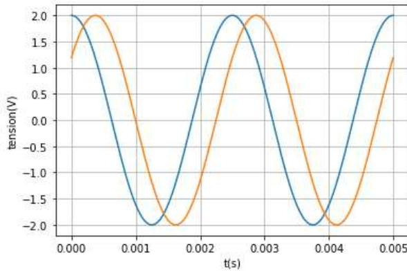
Réponse:  $\underline{H} = \frac{1 - jRC\omega}{1 + jRC\omega}$
