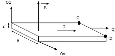
19.a. En régime permanent les électrons se déplacent dans la direction  $Oy$ . Montrer que la vitesse des électrons de conduction s'écrit:  $v = \frac{I}{ne a \epsilon}$  où  $n$  est nombre d'électrons libres par unité de volume.
