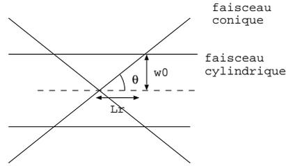
Le faisceau conique diverge et la largeur de la tache sur la lune est donnée par  $\tan \theta \approx \theta = \frac{d_L/2}{D}$  soit  $d_L = 2D\theta = 97 \text{ km}$ .
