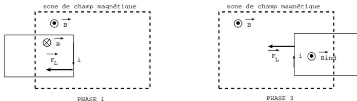
Phase 1: la luge entre dans la zone de champ magnétique: la surface de la luge plongée dans le champ magnétique augmente, donc le flux magnétique augmente, pour limiter cette augmentation du flux, il apparaît un champ magnétique induit opposé au champ magnétique existant. On en déduit le sens de  $i$  (sens horaire) soit  $i < 0$ .
