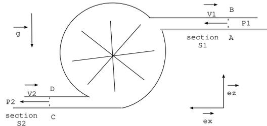
On considère le système ouvert et fixe  $\Sigma$  compris entre  $AB$  et  $CD$ . Définir un système fermé contenant  $\Sigma^*$  et déduire du théorème de la puissance mécanique appliqué à  $\Sigma^*$  la puissance fournie par l'hélice au fluide.
