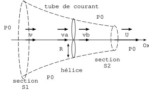
1. Justifier l'allure du tube de courant porté sur le schéma précédent.
