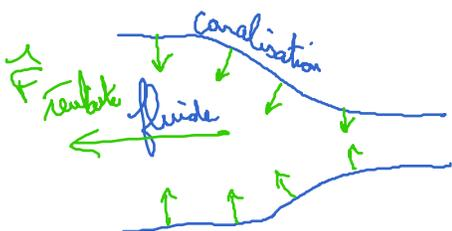
fluide parfait, les forces de la canalisation sur le fluide sont  $\perp$  à la surface en tout point
