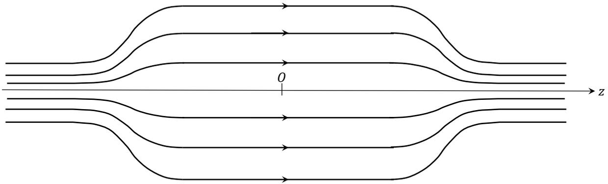
**Figure 3** - Lignes de champ d'une bouteille magnétique
