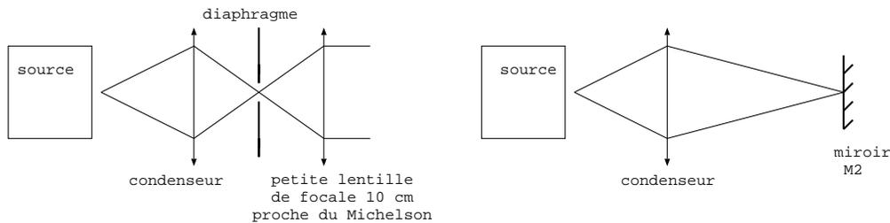
Le mode d'éclairage de gauche peut être remplacé par la lampe source seule dans le cas de la lumière blanche car pour cette source on peut régler le tirage et faire en sorte que le faisceau émis soit un faisceau de lumière parallèle.
