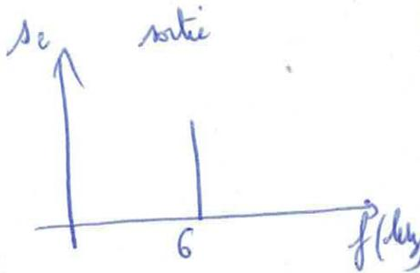
Le filtre a coupé les basses et hautes fréquences, c'est un filtre passe-bande de résonance voisine de 6 kHz et ses fréquences de coupure sont inférieures à 3 kHz et supérieures à 9 kHz.
