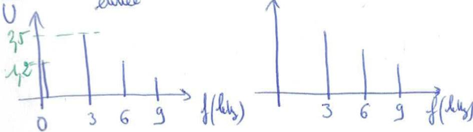
Le filtre a coupé la composante à 0 Hz et a laissé passer les composantes à 3 kHz, 6 kHz et 9 kHz : c'est un filtre passe-haut dont la fréquence de coupure est inférieure à 3 kHz.
