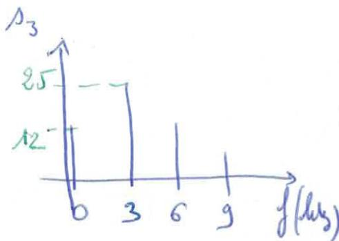
Le filtre a laissé passer toutes les fréquences, il a multiplié les composantes par 10 : filtre amplificateur
