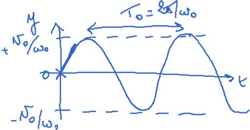
Tracé de la fonction pour  $y_0 > 0$  et  $v_0 = 0$
