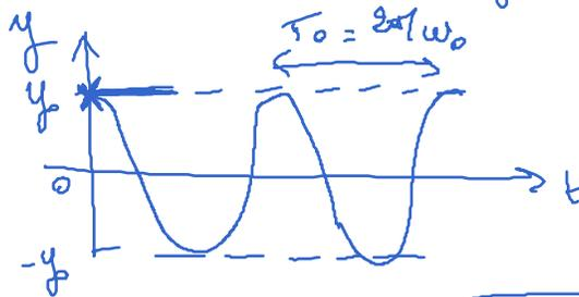
Exemple 2: on cherche la fonction  $y(t)$  qui vérifie l'équation différentielle de la forme  $\ddot{y}(t) + \omega_0^2 y(t) = \omega_0^2 y_e$  où  $\omega_0$  et  $y_e$  sont des constantes.
