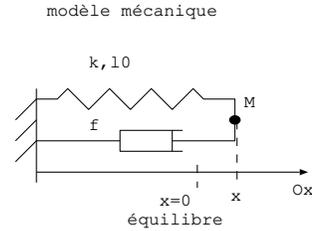
1. Dédurre de la RFD appliquée à  $M$  que l'équation différentielle vérifiée par la variable  $X = x - l_0$  se met sous la forme  $\ddot{X} + \frac{\omega_0}{Q} \dot{X} + \omega_0^2 X = A \cos(\omega t)$ . Exprimer et calculer numériquement  $\omega_0$ ,  $A$  et  $Q$ .
