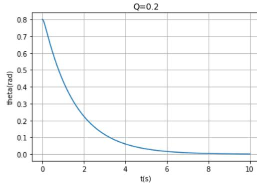
La durée du régime transitoire dépend de l'intensité des frottements mais l'oscillateur finit toujours par s'immobiliser. On peut obliger le système à osciller à la pulsation  $\omega$  (par exemple, pour le pendule, en déplaçant son point d'attache  $O$ :  $x_O(t) = A \cos(\omega t)$ ). Dans ce cas, l'oscillateur amorti vérifie une équation différentielle de la forme :
