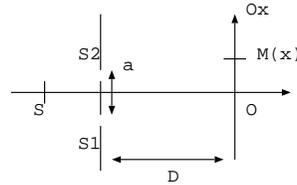
3. Dans le dispositif d'Young, on ajoute derrière la fente  $S_1$  une lame de verre d'indice  $n$  et d'épaisseur  $e$ . On fait l'hypothèse selon laquelle les rayons lumineux sont peu inclinés par rapport à l'axe optique donc la lame est traversée en incidence quasi normale et les rayons qui traversent la lame ne sont pas déviés.
