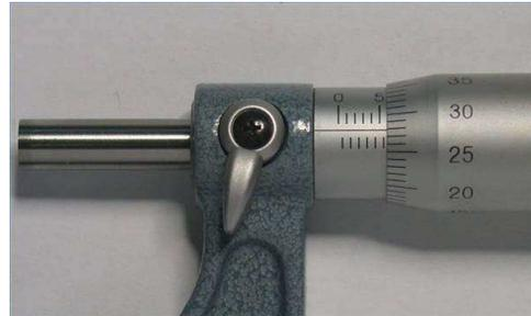
Réponse:  $x_0 = 5,78 \text{ mm}$ ,  $x_1 = 6,07 \text{ mm}$  et  $x_2 = 5,49 \text{ mm}$
