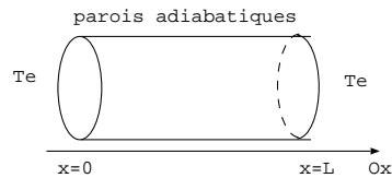
La température initiale dans le cylindre n'est pas homogène, elle s'écrit  $T(x, 0) = T_e + (T_m - T_e) \sin(\frac{\pi x}{L})$ . Le cylindre est donc le siège d'un phénomène de conduction thermique. On cherche à étudier  $T(x, t)$ , la température dans le cylindre en fonction du temps.
