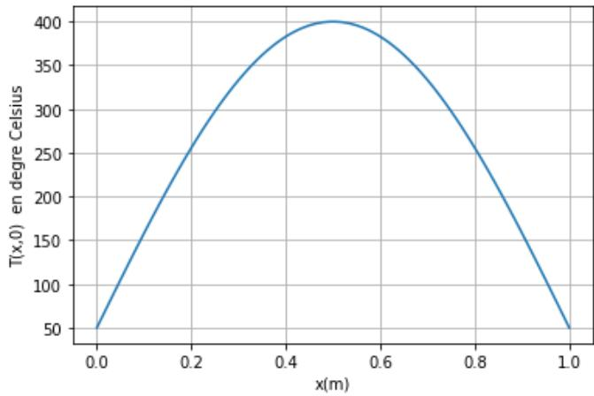
Compléter le code à partir de la courbe obtenue. Prévoir qualitativement l'évolution de la température dans le cylindre au cours du temps.
