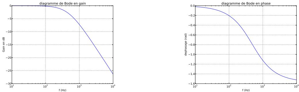
On lit pour  $f = 1 \text{ kHz}$ :  $\phi(1 \text{ kHz}) = -1,15 \text{ rad}$  et  $G_{dB} = -7,5 \text{ dB}$  soit  $G(1 \text{ kHz}) = 10^{-7,5/20} = 0,42$ .
