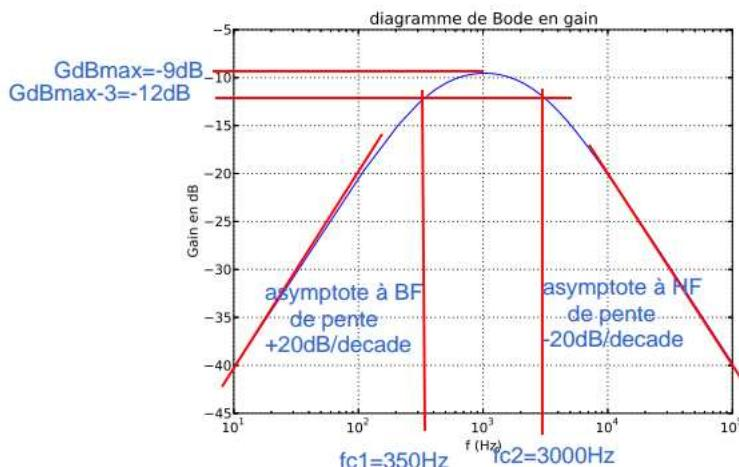
remarque: pour un filtre passe-bande, les fréquences de coupure servent à trouver la valeur du facteur de qualité: On a  $Q = \frac{f_0}{f_2 - f_1}$  avec  $f_0$ : fréquence de résonance (fréquence pour le gain maximum) et  $f_1$  et  $f_2$ : fréquences de coupure.
