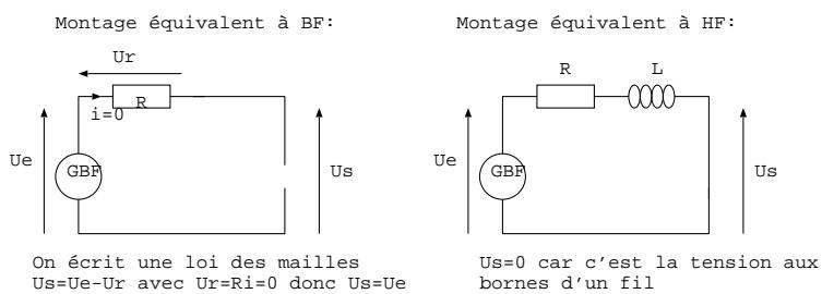
Ce filtre laisse passer les BF et coupe les HF, c'est un filtre passe bas.
