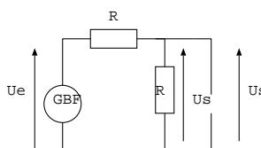
$U_s$  est aussi la tension aux bornes de  $R$ , on applique le diviseur de tension:  $U_s = R/(R+R) U_e = U_e/2$
