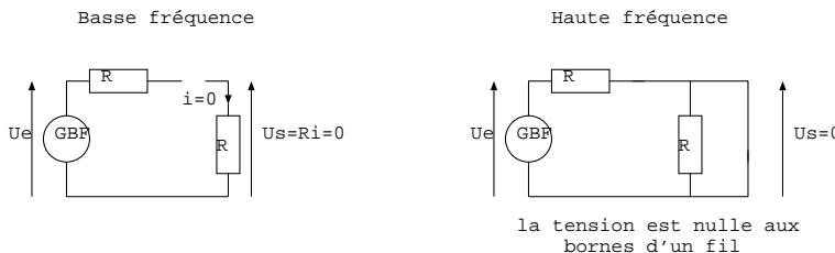
Le filtre coupe les BF et les HF, c'est un filtre passe bande.
