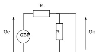
$U_s = 0$  car c'est la tension aux bornes d'un fil
