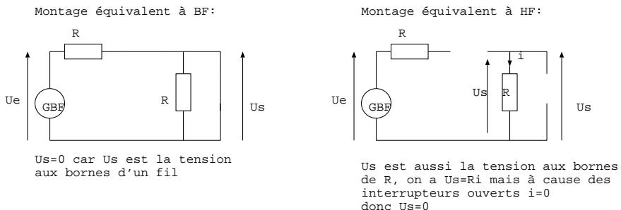
Ce filtre coupe les BF et les HF, c'est un filtre passe bande.
