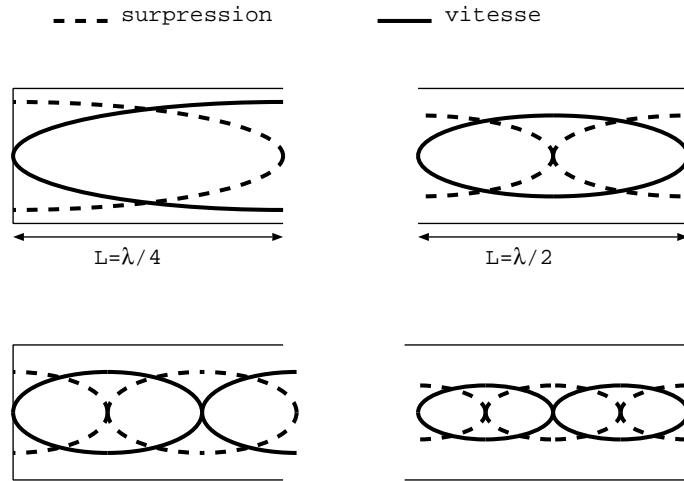
On applique ensuite  $f = \frac{c}{\lambda}$  soit  $f = \frac{c}{2L}$  pour le tuyau ouvert aux deux bouts et  $f = \frac{c}{4L}$  pour le tuyau ouvert d'un côté et fermé de l'autre.
