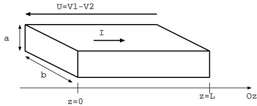
8. Un ruban d'argent de largeur  $a$ , d'épaisseur  $\epsilon$  est parcouru par un courant  $I$ . Ce sont les électrons libres de charge  $-e$  qui assurent la conduction du courant. On note  $n^*$  la densité volumique d'électrons de conduction. Ce ruban est placé dans un champ magnétique uniforme  $B$ , normale au plan du ruban. On mesure la différence de potentiel  $U_H = V(C) - V(D)$ .
