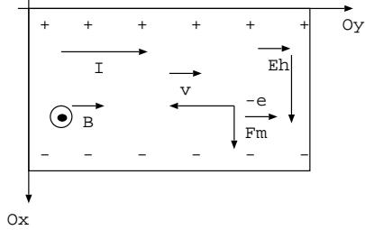
8c- En régime permanent, les forces exercées sur les électrons se compensent selon  $Ox$  soit  $-e \vec{E}_h - e \vec{v} \wedge \vec{B} = \vec{0}$  soit  $\vec{E}_h = -\vec{v} \wedge \vec{B} = v B \vec{e}_x = \frac{IB}{n^* e a \epsilon}$ .
