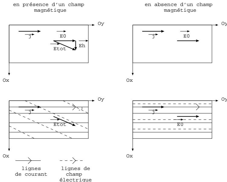
$$3. \text{ On a } \vec{E}_h = -\frac{\vec{j}}{n^*e}\Lambda\vec{B} \text{ avec } \vec{j} = j\vec{e}_y = \frac{I}{ab}\vec{e}_y \text{ soit } \vec{E}_h = -\frac{I\vec{e}_y}{abn^*e}\Lambda B\vec{e}_z = \frac{-IB}{abn^*e}\vec{e}_x.$$
