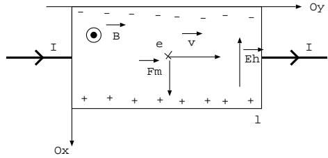
2. Selon  $Ox$  les charges subissent deux forces: la force magnétique  $\vec{F}_m = e\vec{v}\Lambda\vec{B}$  et la force électrique  $\vec{F}_e = e\vec{E}_h$ .
