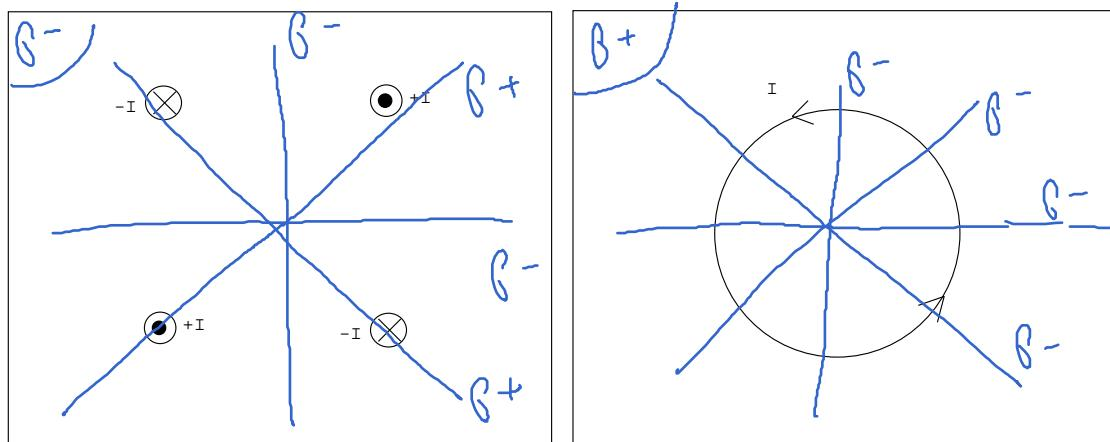
3. Conséquences sur le champ magnétique: Les symétries permettent de trouver la direction de  $\vec{B}(u)$
