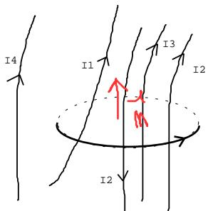
$$I_{\text{enlacés}} = +I_1 + I_3 + I_2 - I_4$$
