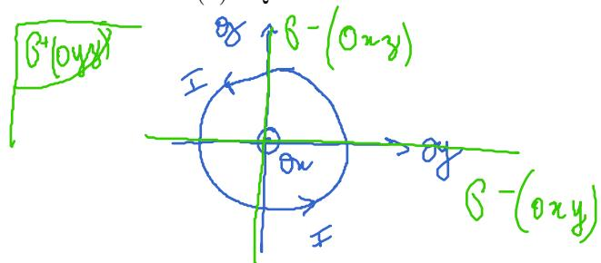
$M(x)$  et  $M'(-x)$  sont symétriques / au plan  $\mathcal{B}^+(0_{xy})$  donc  $\vec{B}(x)$  et  $\vec{B}(-x)$  sont antisymétriques / à ce plan
