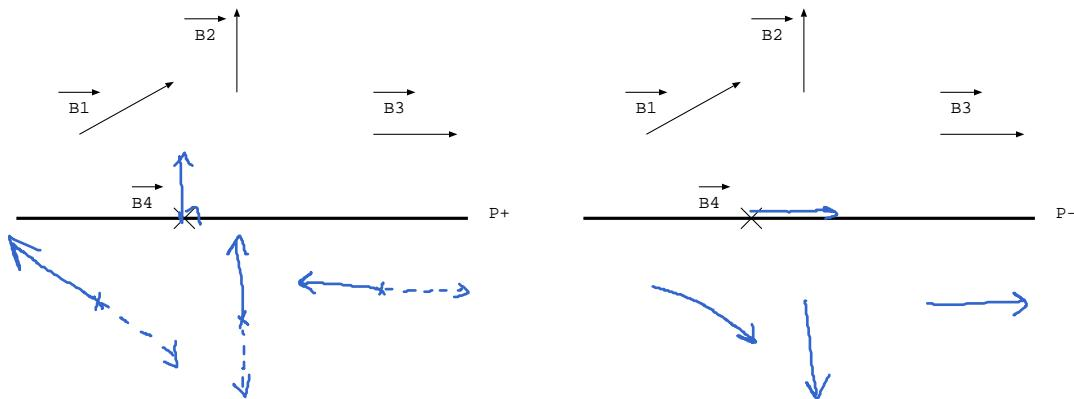
Exemple 1 : On donne le magnétique créé par un fil infini en trois points différents. Utiliser les propriétés de symétrie pour tracer le champ magnétique aux neuf autres points indiqués sur le schéma. En déduire le tracé des lignes de champ.
