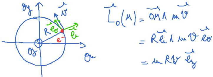
L'électron en mouvement crée un courant électrique dans une boucle circulaire. Exprimer en fonction des données le moment magnétique  $\vec{M}$  de cette boucle de courant.
