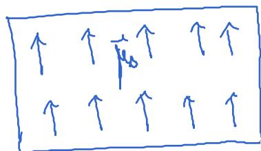
les moments magnétiques de chaque atome s'orientent dans la direction et le sens de  $\vec{B}_0$ . Le moment résultant est  $\vec{M} = N \times \mu_B \vec{e}_y$
