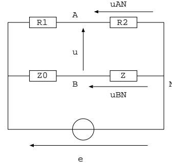
7. Le pont de Sauty est équilibré pour  $R_2 \underline{Z}_0 = R_1 \underline{Z}$  avec  $\underline{Z} = \frac{\underline{Z}_R \underline{Z}_C}{\underline{Z}_R \underline{Z}_C} = \frac{R \frac{1}{jC\omega}}{R + \frac{1}{jC\omega}} = \frac{R}{1 + jRC\omega}$  (association  $R//C$ ). De la même façon on a  $\underline{Z}_0 = \frac{R_0}{1 + jR_0 C_0 \omega}$ .
