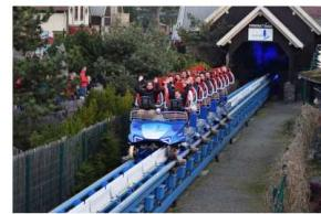
Le dispositif qui permet d'accélérer initialement le train dans le Blue Fire est nommé moteur linéaire synchrone. Le principe est le suivant: des aimants permanents sont placés sous les wagons du train et un champ magnétique est généré par des circuits électriques situés dans les pièces blanches du stator, solidaires du rail. L'interaction entre ce champ magnétique et les aimants du train explique la force propulsive responsable de l'accélération.
