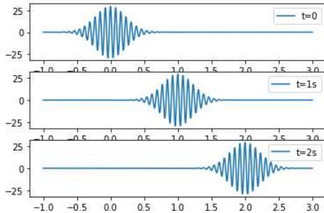
Exemple de propagation dans un milieu dispersif: le paquet d'onde gaussien avec  $f_{min} = 10 \text{ Hz}$  et  $f_{max} = 16 \text{ Hz}$  se propage dans un milieu où la relation de dispersion est  $k = \sqrt{\omega}$
