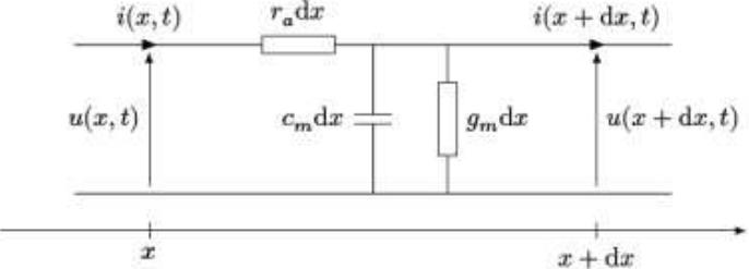
$r_a$ ,  $g_m$  et  $c_m$  désignent respectivement la résistance linéïque, la conductance linéïque et la capacité linéïque de l'axone.
