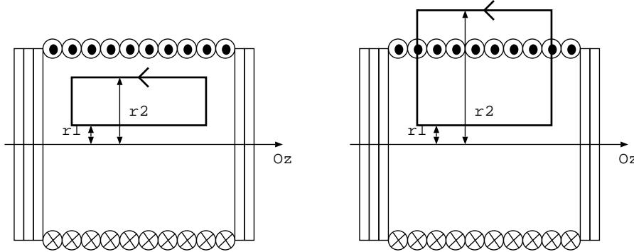
On choisit dans un premier temps  $r_1 < r_2 < R$ : le contour n'enlace aucun courant donc d'après le théorème d'Ampère  $C = \mu_0 I_{enlaces} = 0$  soit  $B(r_1) = B(r_2)$ : le champ magnétique est uniforme dans le solénoïde.
