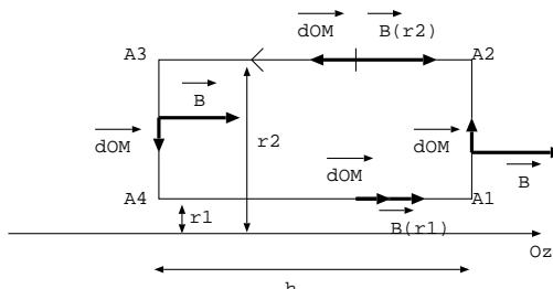
On calcule la circulation de  $\vec{B}$  sur ce rectangle:  $C = \int \vec{B}(M) \cdot d\vec{OM} = \int_{A_2}^{A_3} B(r_2) \vec{U}_z \cdot dl(-\vec{U}_z) + \int_{A_4}^{A_1} \vec{B}(r_1) \vec{U}_z \cdot dl(\vec{U}_z) = (B(r_1) - B(r_2))h$ .
