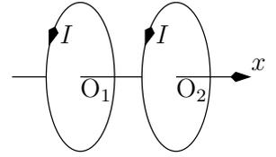
Soit  $O$  le point situé au milieu des deux points  $O_1$  et  $O_2$ . La distance entre les centres des deux bobines est  $d$ . Soit  $x$  l'abscisse d'un point  $M$  de l'axe  $(Ox)$  telle que  $OM = x$ . Les deux bobines sont parcourues par le même courant  $I$  dans le même sens.
