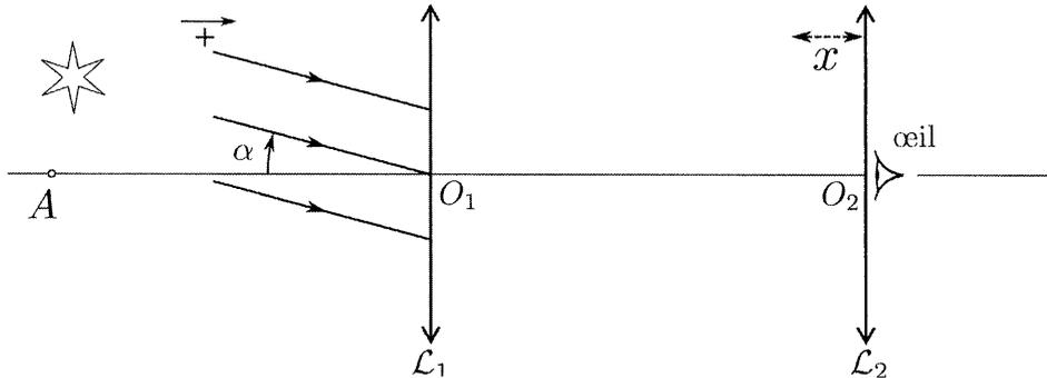
On note  $d_m = 25$  cm la distance entre l'œil et son punctum proximum, c'est-à-dire, la distance minimale de vision nette. Les foyers principaux objets et images de  $\mathcal{L}_1$  et  $\mathcal{L}_2$  sont notés respectivement  $F_{o,1}$ ,  $F_{i,1}$  et  $F_{o,2}$ ,  $F_{i,2}$ . Dans tout l'exercice, on admet que les conditions de Gauss sont satisfaites.
