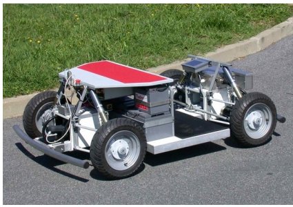
FIGURE 3 – Ensemble {châssis – train roulant} du véhicule RobuCar
