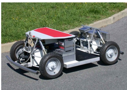
FIGURE 3 – Ensemble {châssis – train roulant} du véhicule RobuCar
