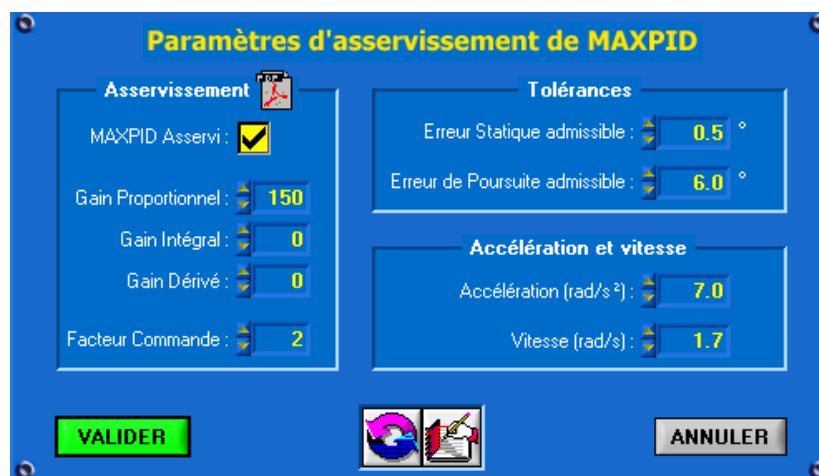
FIGURE 2 – Fenêtre des paramètres d'asservissement : laisser les réglages PID inchangés.
