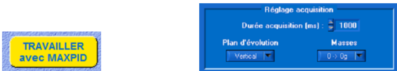
FIGURE 1 – Depuis l'accueil du logiciel Maxpid, accéder au travail avec le système, puis régler la durée d'acquisition.
