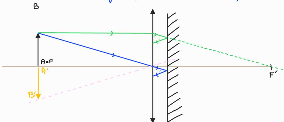
④ Ils ne reste plus qu'à tracer les rayons en sortie de lentille, après réflexion sur le miroir plan.
